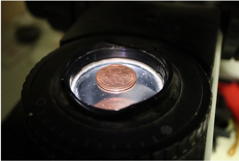
Figura 1. Moneda de un céntimo colocada en el centro del condensador para que actúe como el disco opaco presente en los condensadores de microscopio de campo oscuro.
