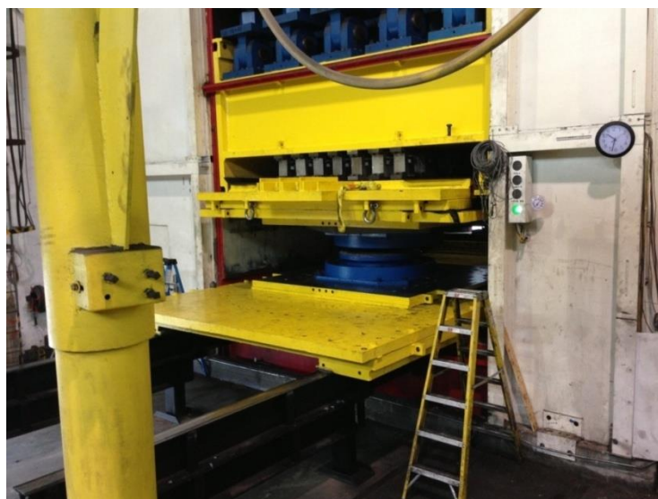
Figura 9. Ensayo de un apoyo triple esférico en la fábrica de EPS en California (USA)
