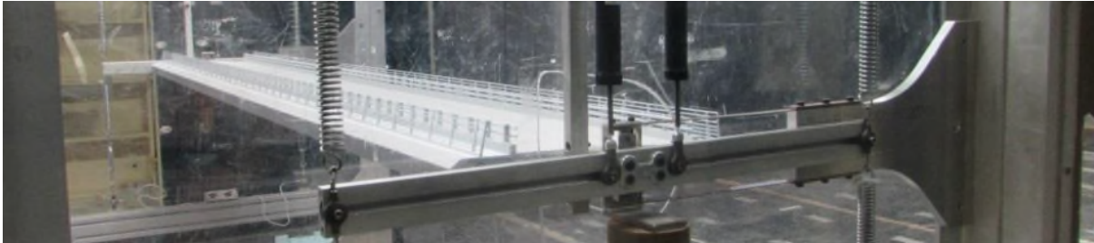
Figura 4. Ensayo seccional de túnel de viento.
