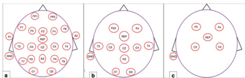
a Montaje cabeza completa. b Montaje reducido para neonatos. c Montajes para EEG de amplitudes integradas. Electrodos usados para montajes en neonatos, basados en Sistema 10-20 internacional (GND=tierra; REF=referencia).
